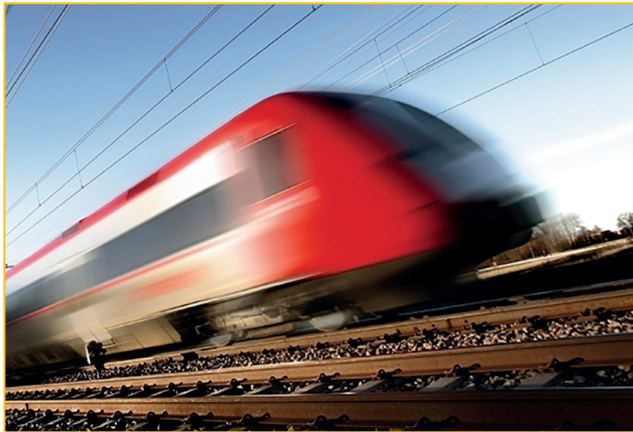
Abb. 10: Lärm durch Eisenbahnverkehr: Die Wechselwirkung zwischen Rad und Schiene bewirkt, dass die Räder, Schienen und Schwellen schwingen [5] und dadurch Luftschall erzeugen.
